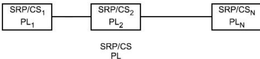
Рисунок 13 - Комбинирование SRP/CS<sub>i</sub> с целью достижения общего PL
