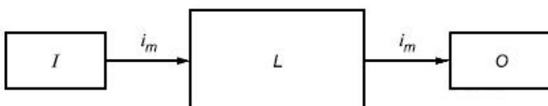
$i_m$  - средства связи; I - входное устройство, например, датчик; L - логический блок; О - выходное устройство, например, главный kontaktor
