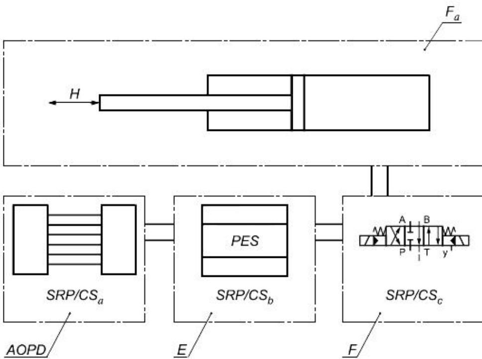
AOPD - активное оптоэлектронное защитное устройство (например, световой барьер),  $SRP/CS_a$ : категория 2 [тип 2],  $PL=c$ ;  $E$  - электронная логическая схема управления,  $SRP/CS_b$ : категория 3,  $PL=d$ ;  $F$  - гидрораспределитель,  $SRP/CS_c$ : категория 1,  $PL=c$ ;  $F_a$  - гидроцилиндр;  $H$  - опасное перемещение
