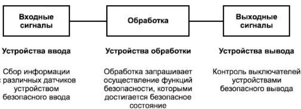
Рисунок 7 - Общая архитектурная модель программного обеспечения
