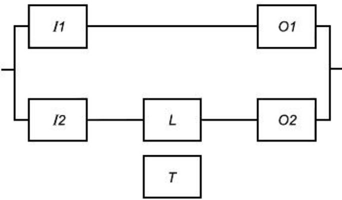
I1 и О1 формируют первый канал (последовательная группировка); I2, L, О2 формируют второй канал, т.е. функция безопасности имеет два канала (параллельная группировка). Т используется только для тестирования.
