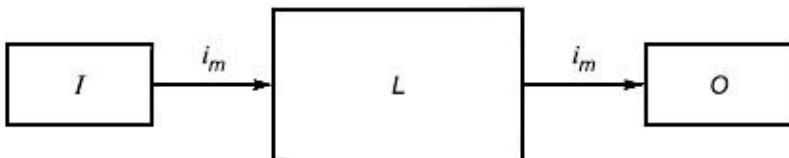
$i_m$  - средства связи; I - входное устройство, например, датчик; L - логический блок; O - выходное устройство, например, главный контактор
